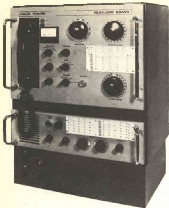
Modello del radiotelefono Pentland a singola banda laterale, progettato per imbarcazioni di grandi dimensioni. L'aspetto esterno del tipo Alpha è simile a quello del Bravo, riprodotto nella fotografia qui sopra.
