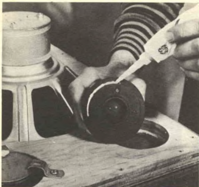
Fig. 2 - Per ottenere una buona tenuta d'aria, la parte posteriore dei cestelli degli altoparlanti deve essere spalmata con gomma al silicone. Si noti che per il fissaggio dei tweeter si sono adoperati dei fermacavi.
