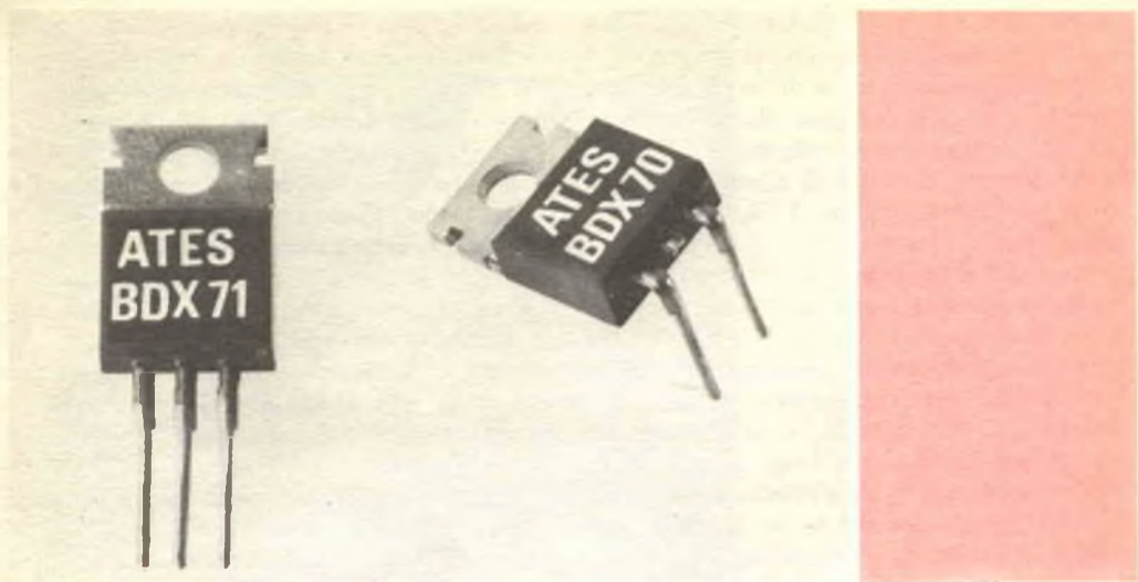
Fig. 3 - Ecco i due nuovi transistori di potenza Hometaxial della SGS/ATES.
