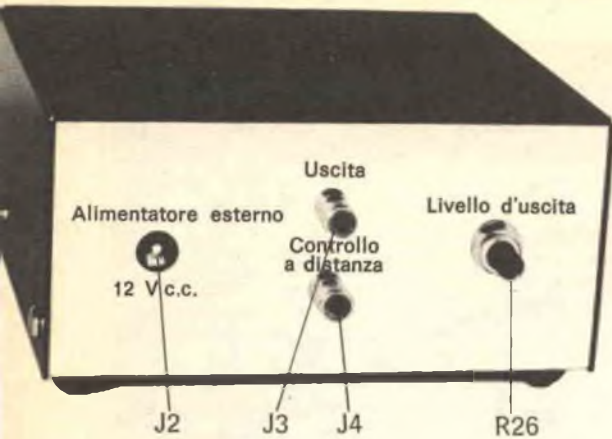
Ecco la parte posteriore del compressore. Si vedono il jack per l'alimentatore esterno, i terminali d'uscita e di controllo a distanza e il controllo d'uscita.
