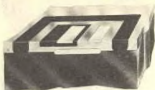
Fig. 6 - Transistore integrato bipolare (N-P-N) in cui i componenti sono stati isolati l'uno dall'altro mediante regioni P + diffuse in profondità.
