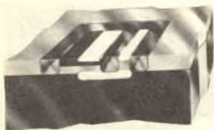
Fig. 7 - Transistore integrato bipolare (N-P-N) in cui i componenti sono stati isolati l'uno dall'altro mediante regioni spesse di ossido immerse, che delimitano in superficie la regione di base e la zona di contatto di collettore.
