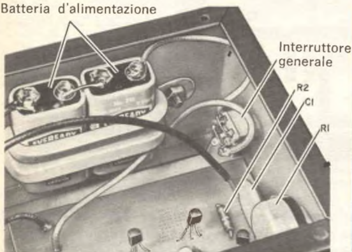
Fig. 3 - Le due batterie da 9 V per transistori, collegate in serie, si possono fissare alla scatola con staffette a U o con una piccola maniglia per cassette.
