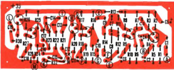
Fig. 2 - Circuito stampato in grandezza naturale per il preamplificatore; per lo stereo ne occorrono due.
