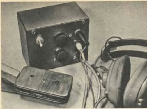
Il cercametalli è composto dalle bobine di ricerca, dalla cuffia e dalla parte elettronica.
