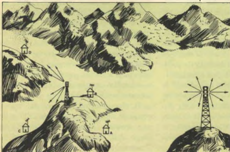
Fig. 1 - Il trasmettitore principale, a destra, serve una vasta zona di pianura ed irradia energia in tutte le direzioni. Il ripetitore ad esso collegato serve invece esclusivamente le due valli interne e quindi non viene ricevuto né in A né in B.
