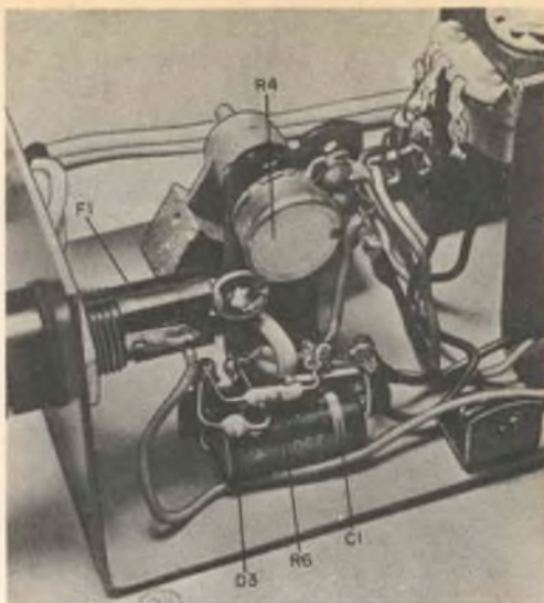
Per fissare il coperchio si usano staffette ad angolo retto, forate e filettate come quella che si vede in questa figura, in basso a destra.
