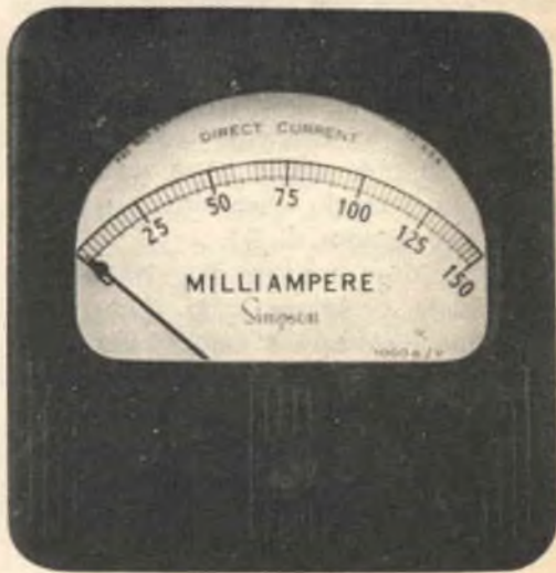
A sinistra è rappresentato lo strumento prima della modifica del quadrante spiegata nel testo. A destra si vede invece lo stesso strumento con il quadrante modificato per la portata di 150 mA f.s.
