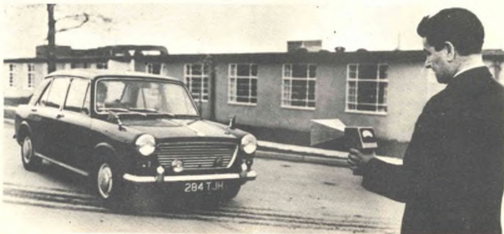
Fig. 4 - Tachimetro radar miniatura mentre misura la velocità di un'autovettura.
