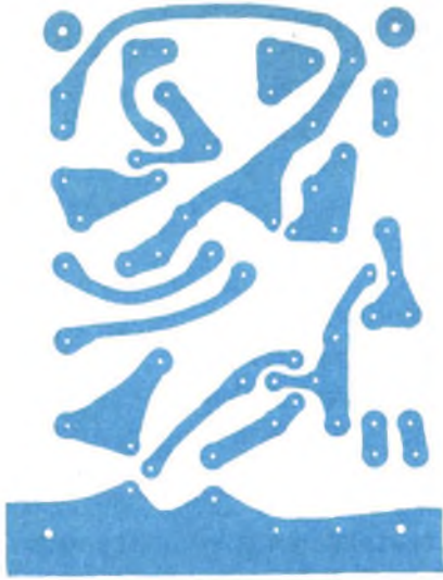
Fig. 2 - Circuito stampato in grandezza naturale per l'amplificatore. I due transistori di potenza ed i componenti ad essi relativi, a causa del calore dissipato, sono montati esternamente.
