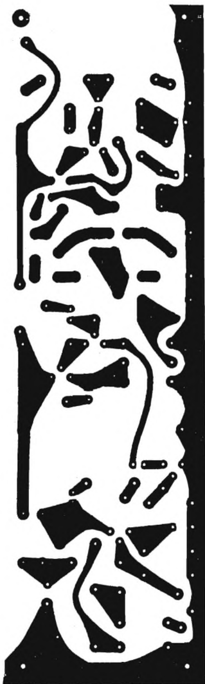
Fig. 6 - Circuito stampato in grandezza naturale per il preamplificatore per strumenti musicali. Il preamplificatore si può anche usare indipendentemente con ogni sistema d'amplificazione per strumenti musicali.
