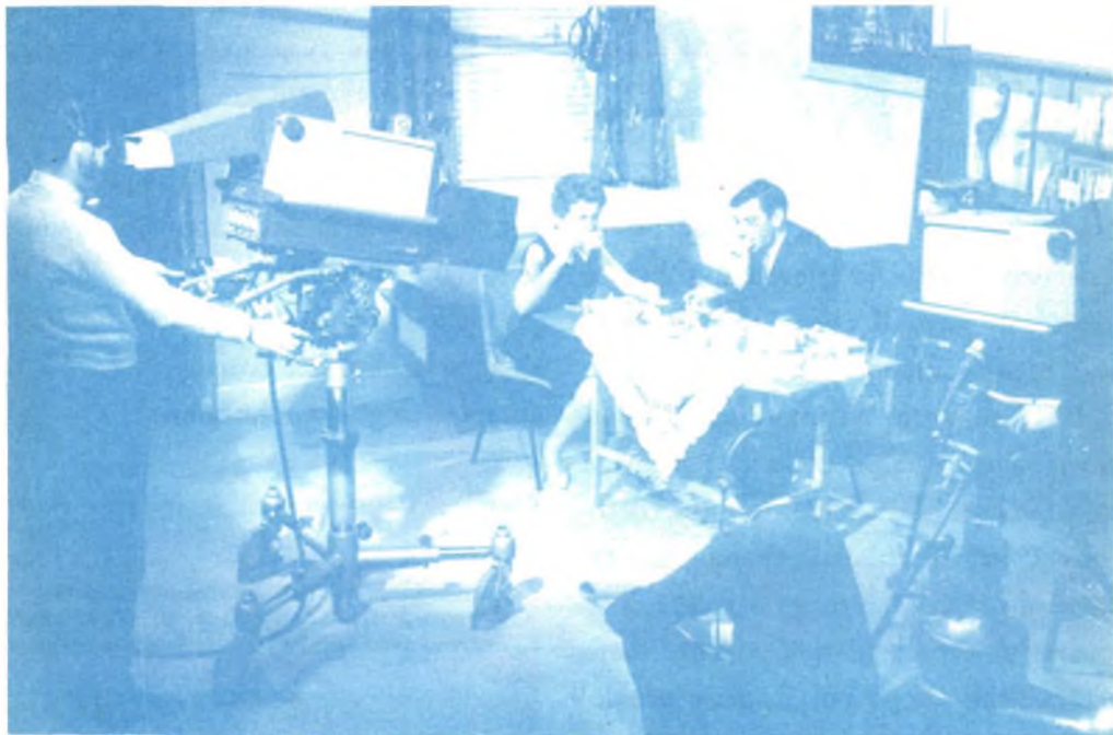
Ecco due camere televisive a transistori della Marconi funzionanti in uno studio. Il mirino inclinabile permette ai due cameramen di stare in posizione comoda con angoli della camera bassi od alti.
