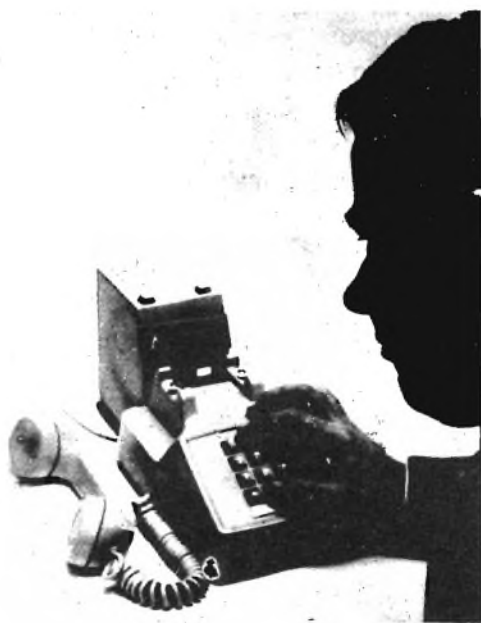
Ecco il dispositivo sperimentale, costruito dai Bell Telephone Laboratories, che in futuro permetterà ai sordi di comunicare telefonicamente.
