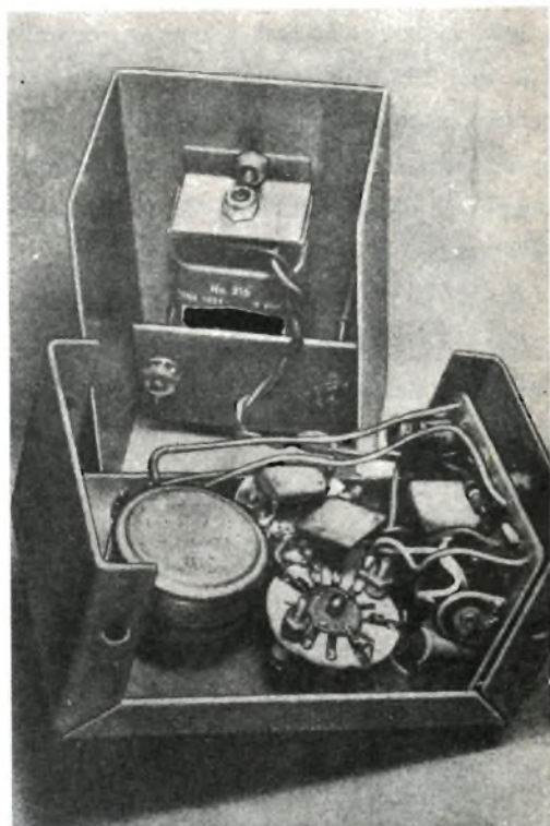
Fig. 4 - La batteria è montata nella parte posteriore della scatola per cui, quando quest'ultima è chiusa, non può venire a contatto con R2, S1, S2 oppure con i componenti montati sul circuito.
