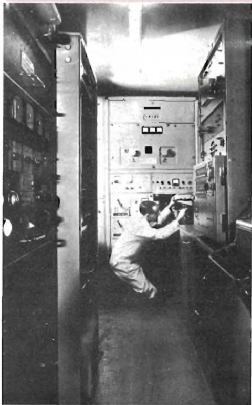
Fig. 2 - Trasmettitore Marconi di grande potenza, ad autosintonia, realizzato con tecniche nuove.
