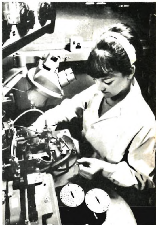
Fig. 1 - Montaggio, in un'industria elettronica inglese, di transistori più piccoli di una capocchia di spillo, mediante attrezzature ad alta velocità dotate di un microscopio stereo e di lenti zoom.
