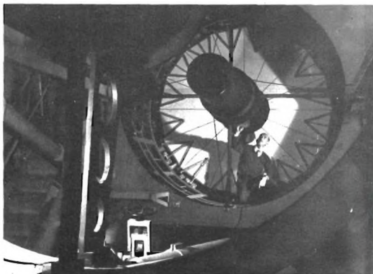
Fig. 2 - Un collaudatore esamina l'involucro a petali del telescopio britannico Isaac Newton da 250 cm di diametro.
