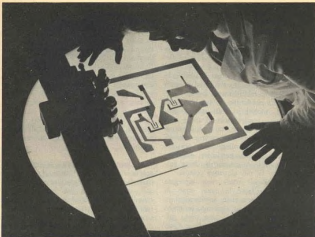
Proiezione fortemente ingrandita di un circuito stampato miniaturizzato realizzato dalla Philips.
