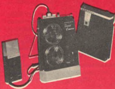
Il microfono, azionato dalla voce, mette in funzione questo registratore quando il suono inizia e lo arresta quando il suono cessa; l'apparecchio funziona con batterie ricaricabili.
