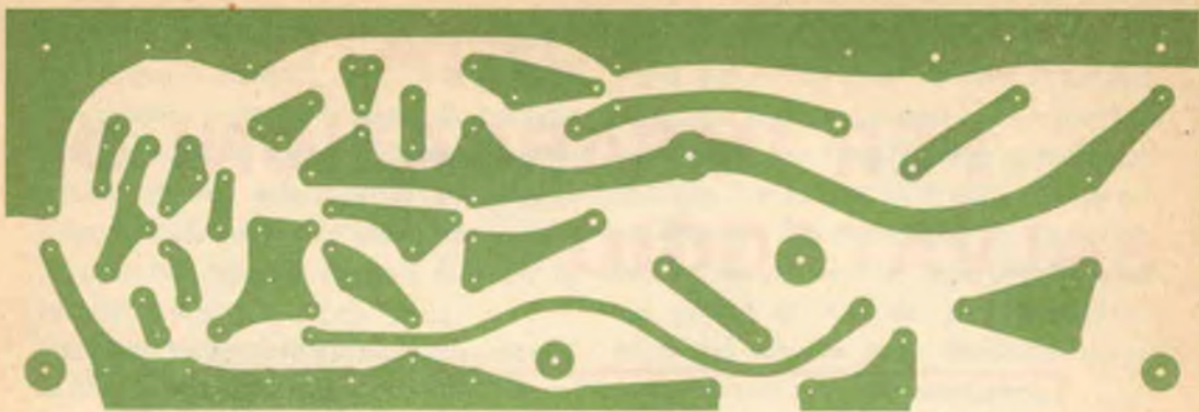
Fig. 6 - Ecco riprodotta, nelle sue reali dimensioni, la tavoletta a circuito stampato.
