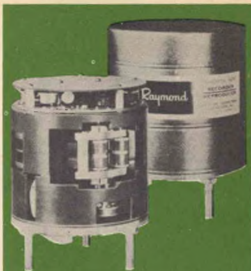
Questo compatto registratore prodotto dalla Raymond registra e riproduce i dati telemetrici MF e digitali in tutte le fasi di volo di un razzo, comprese quelle d'accensione, di spinta, di separazione dello stadio e del rientro. L'unità assicura anche uno spostamento di dati nel tempo per la riproduzione in volo durante i periodi telemetrici ottimi ed anche la lettura in laboratorio e sulla rampa di lancio per il controllo finale.
