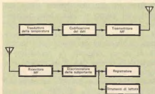
Fig. 2 - Schema a blocchi semplificato di un tipico sistema telemetrico. I dati codificati provenienti dall'apparecchiatura di raccolta vengono trasmessi per la lettura e l'interpretazione ad una stazione trasmittente, per mezzo radio MF.
