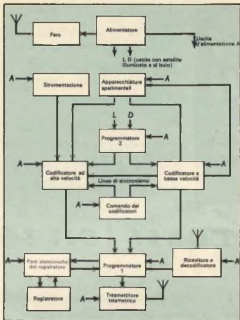
Fig. 4 - Schema a blocchi delle apparecchiature elettroniche delle quali è dotato il satellite.
