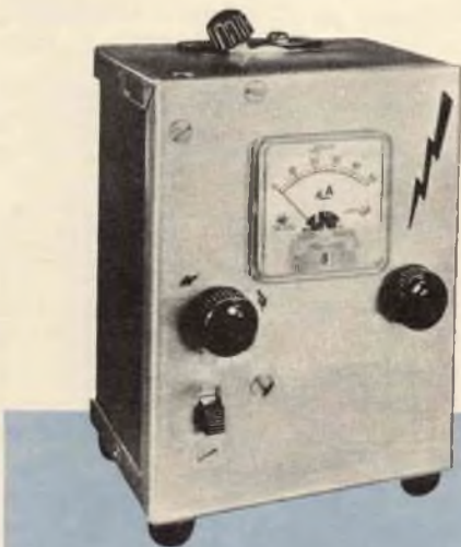
Qui sopra si vede il dispositivo finito, a destra è illustrata la disposizione delle parti; di queste la più importante è un sensibile strumento; né i valori né la disposizione delle parti sono critici.
