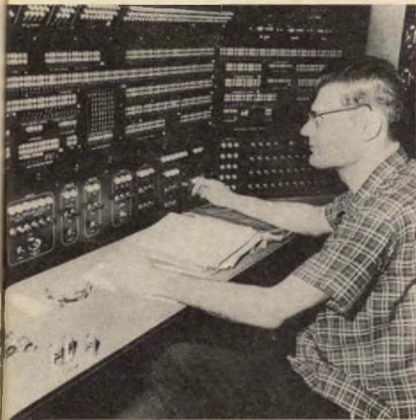
Il proprietario verifica i circuiti del banco di controllo della sua calcolatrice elettronica di ricupero.
