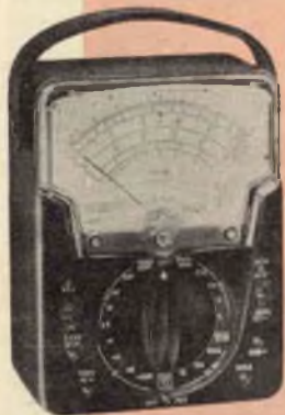
Il tester Triplett 630-L è il primo progettato appositamente per il controllo sia di circuiti con semiconduttori sia di normali circuiti a valvole. Questo tester ha un circuito ohmmetrico a bassa tensione, una bassa portata c.c. di 2,5 V f.s. ed un sensibile strumento adatto per misurare basse correnti.
