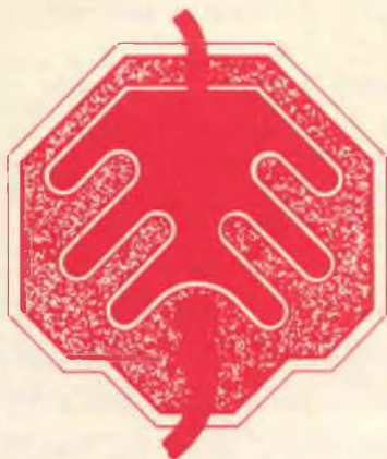
Fig. 4 - Questo disegno, basato su una microfotografia, illustra la configurazione a foglia della nuova serie di transistori piatti al silicio progettati dalla Bendix. I fili collegati sono i terminali di base e di emettitore.
