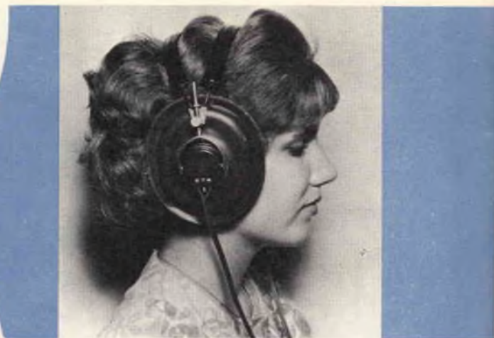
Cuffia che può essere mono o stereo a seconda di come i collegamenti sono stati fatti. I cuscinetti di grandi dimensioni agevolano l'ascolto.
