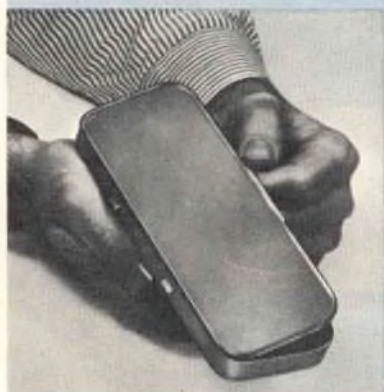
Fig. 7 - Per rimontare lo specchio si introducono, prima di tutto, i perni a linguetta saldati nella cornice nelle fessure praticate nella scatola.
