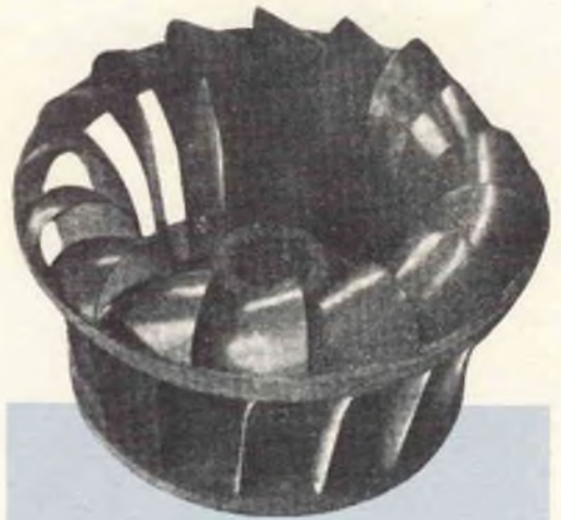
Nella girante di una turbina Francis le pale hanno la caratteristica forma a doppia curvatura.
