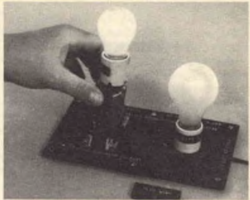
Fig. 3 - Il principio del trasformatore si può dimostrare facilmente sistemando l'insieme di L2/I2 su L1. In L2 viene indotta una tensione sufficiente a far brillare la lampada da 15 W (I2).
