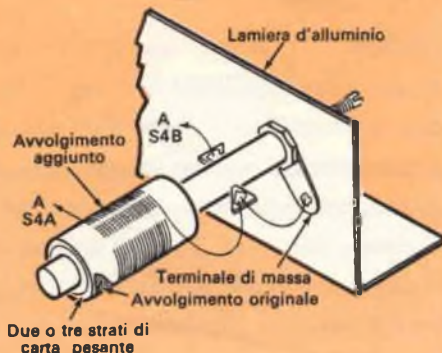
Fig. 3 - Particolare delle bobine L1, L2, L3, L4. L'avvolgimento aggiunto è fatto su un separatore di carta pesante con filo smaltato da 0,40 mm ed è costituito da 22 spire su L1, 12 spire su L2, 12 spire su L3 e 7 spire su L4; la bobina L5 richiede invece un solo avvolgimento.
