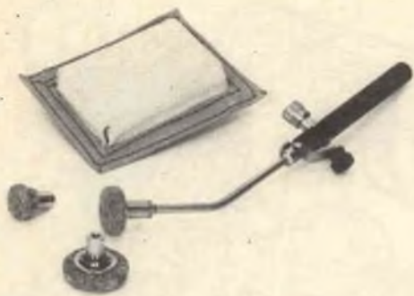
Electrodo con interruttore e tre teste di diverse dimensioni. L'elettrodo piatto si usa umido.
