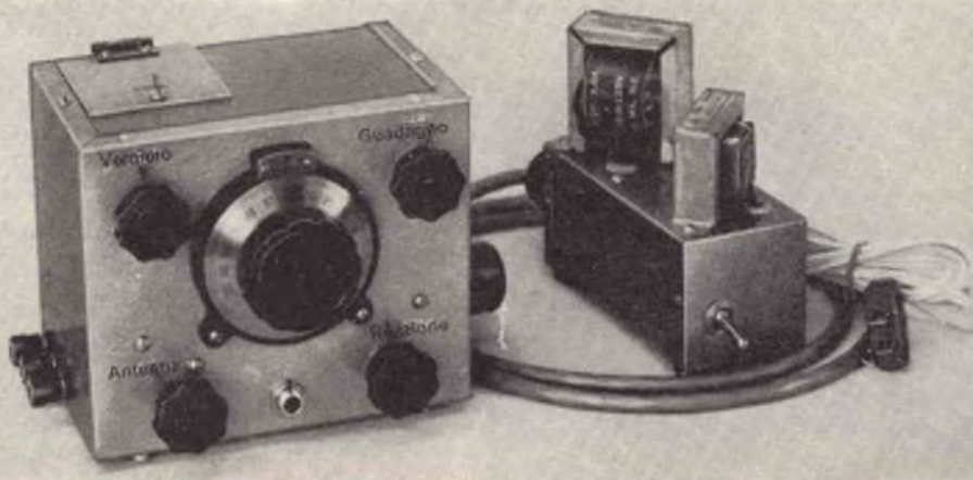
Ricevitore per tutte le gamme e relativo alimentatore pronti per l'uso. Poiché l'assorbimento del ricevitore è abbastanza basso (circa 150 V 25 mA e 6,3 V 1 A), è possibile anche prelevare le tensioni da un altro ricevitore o da un amplificatore facendo in tal modo a meno di costruire appositamente un alimentatore separato.
