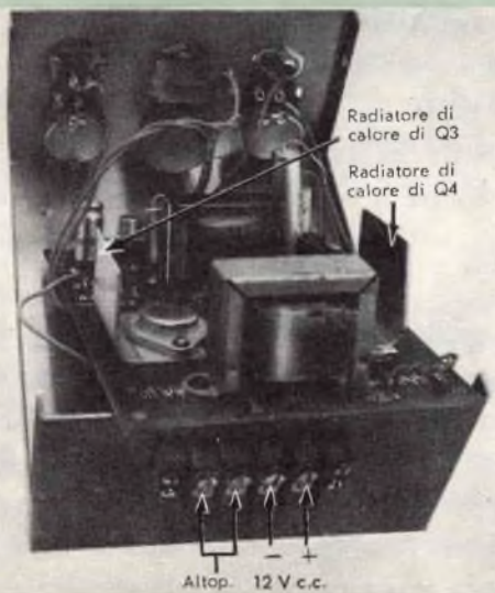
Fig. 3 - Basetta del circuito completa e pronta per essere fissata a posto nella custodia di alluminio.
