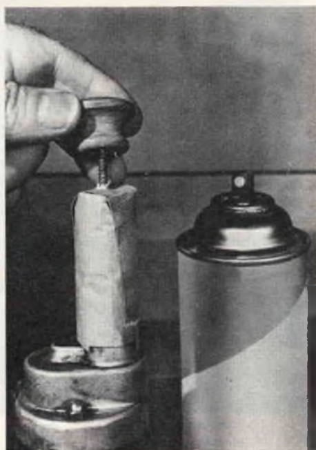
Fig. 5 - Qualsiasi dispositivo che compia un moto rotatorio, come ad esempio il trapano elettrico qui illustrato, può essere impiegato per verniciare uniformemente piccoli pezzi.
