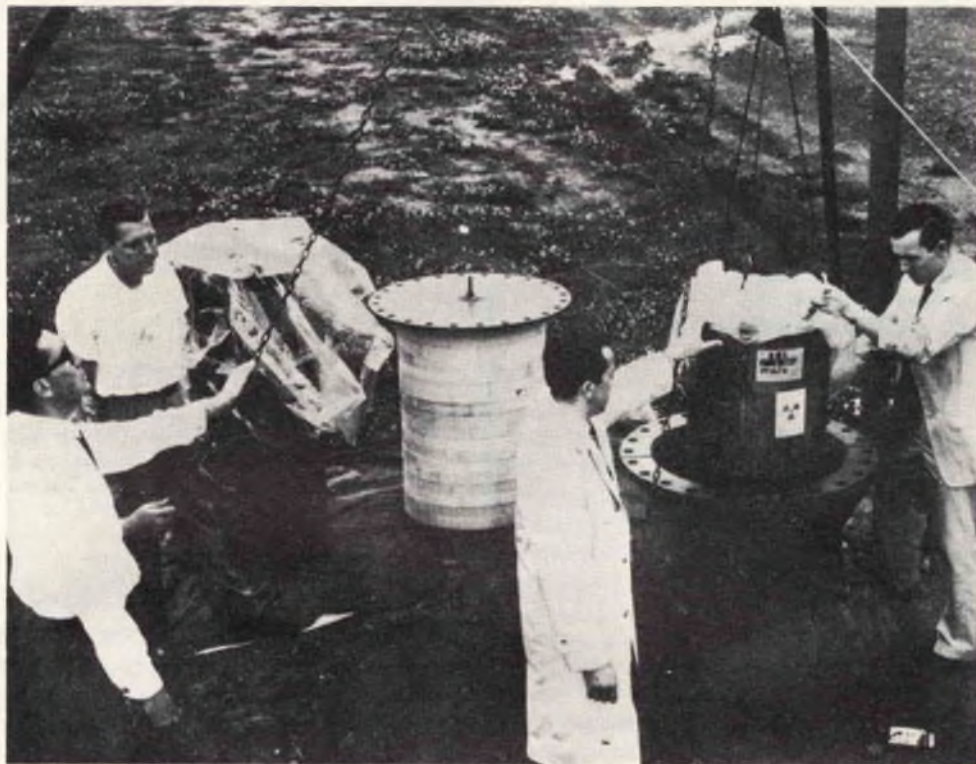
In fotografia si vede il generatore per la stazione, posto in un cilindro semiinterrato, durante le prove effettuate a Baltimora (U.S.A.) presso la fabbrica della Martin Company. Quando la stazione automatica sarà installata funzionerà per due anni senza manutenzione e rifornimento.
