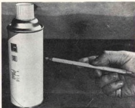
Fig. 4 - Con una testina di spruzzo si possono schizzare gocce di vernice su vecchi mobili, custodie, ecc., che assumono, con questo rapido trattamento, un aspetto nuovo.
