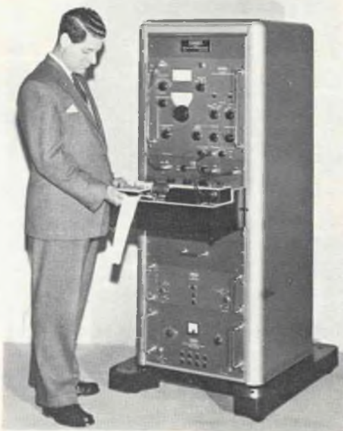
Un ingegnere esamina la registrazione di un'analisi di vibrazione prodotta dall'analizzatore d'onda e registratore automatico K-100, della Muirhead.
