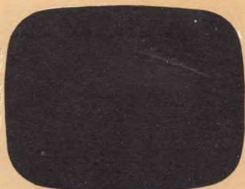
Lo schermo non è illuminato, ma il suono si sente bene. Provate a sostituire successivamente i tubi: oscillatore orizzontale, finale orizzontale, raddrizzatore AAT, economizzatore, raddrizzatore AT, per far scomparire questo difetto.
