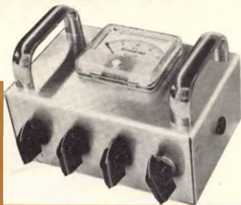
Fig. 2 - La custodia dello strumento contiene un semplice amplificatore in corrente continua con i relativi controlli. Un cavo a tre conduttori (che non compare nella figura) ha il compito d'inviare nell'amplificatore il segnale proveniente dalla camera di ionizzazione.
