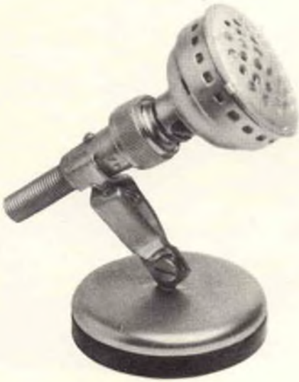
Microfono da tavolo costruito con il fondello di un portalampade e con pochi altri elementi. In basso sono raffigurati i dettagli costruttivi del supporto.
