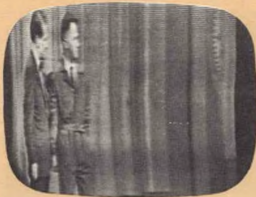
Restringimento orizzontale, spesso dovuta ad esaurimento dei tubi orizzontali o della raddrizzatrice AT. Per eliminare l'inconveniente regalate il controllo di larghezza; sostituite la valvola finale orizzontale e la raddrizzatrice AT.
