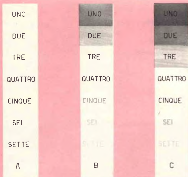
L'esatto tempo di esposizione può essere determinato con queste strisce di prova. La striscia A costituisce l'originale; le strisce B e C sono invece le riproduzioni ottenute con il metodo qui descritto.
