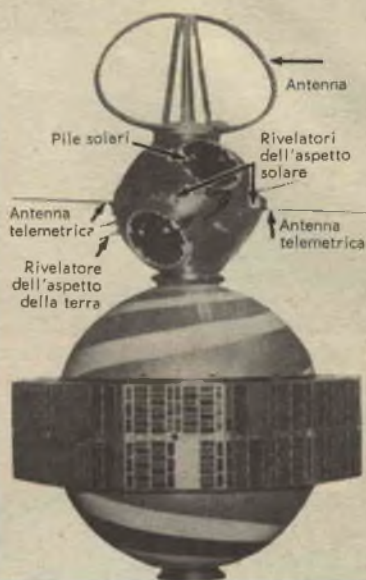
Il "collo" che unisce il Transit III-B al satellite NRL LOFTI non si staccò dopo il lancio avvenuto il giorno 21 febbraio.
