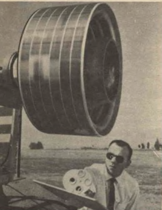
Il satellite rotante, costruito dalla Hughes Aircraft, è un ripetitore attivo; pesa circa 15 kg ed è alimentato da batterie al silicio.
