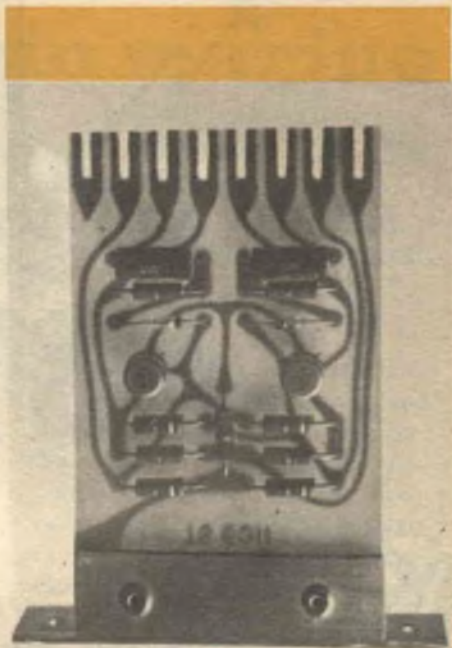
Ecco uno degli elementi premontati, a circuito stampato, posti in vendita ad uso degli sperimentatori per essere impiegati nella costruzione di calcolatrici ed altri circuiti digitali.
