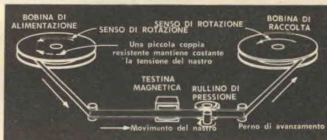
Fig. 1 - Gli elementi essenziali del meccanismo di avanzamento del nastro sono: la bobina di raccolta, la bobina di alimentazione e il perno di avanzamento.
