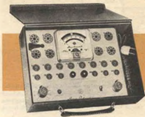
Il provavalvole « rapido » qui illustrato ha numerosi zoccoli con connessioni permanenti, così da ridurre il tempo necessario per le regolazioni preliminari.
