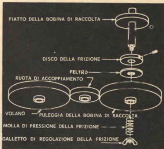
Fig. 3 - Sistema di trasmissione con frizione a disco. L'entità dello slittamento viene determinata serrando od allentando il galletto di regolazione della frizione.
