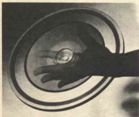
Fig. 3 - Il vocabolario a disco di vetro immagazzina le parole sotto forma codificata binaria; dopo ogni parola russa codificata si trova codificata la parola inglese corrispondente.
