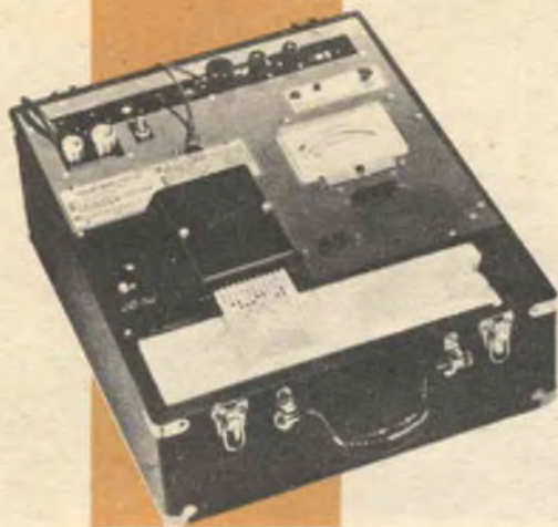
Un provavalvole di tipo rivoluzionario applica il principio delle moderne calcolatrici nella prova delle valvole; ciascuna scheda perforata corrisponde ad un particolare tipo di valvola da provare.
