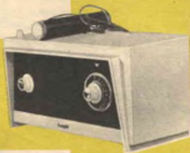
L'apparecchio che si vede nella foto qui sopra invia i segnali attraverso la rete luce fino all'elemento ricevente formato dalla bobina che si vede a sinistra sopra l'apparecchio radio.
