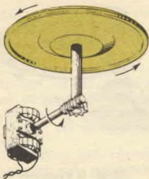
Fig. 1 - La trasmissione diretta mediante ingranaggi è usata nei giradischi per registrazioni, nei quali si richiede una maggior potenza meccanica da trasmettere.
