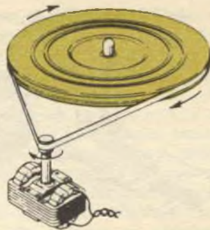
Fig. 3 - La trasmissione diretta con cinghia è molto usata nei giradischi ad una sola velocità: la cinghia contribuisce ad isolare le vibrazioni del motore.
