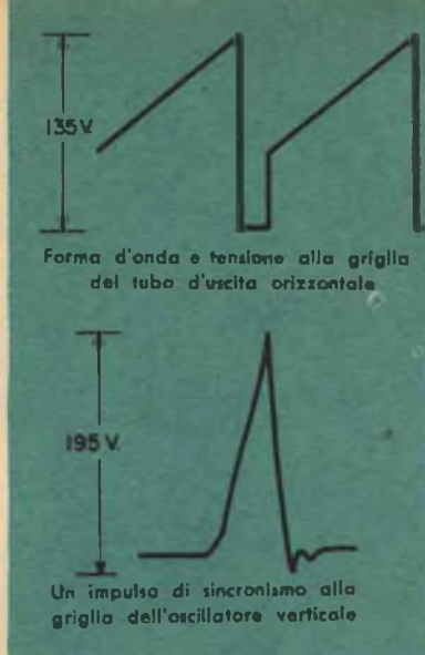
Fig. 3 - Tipiche forme d'onda in un comune televisore.
