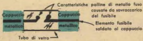
Fig. 1 - Due tipi di guasti ai fusibili. La fusione (A) indica generalmente corrente eccessiva dovuta a cortocircuito momentaneo o permanente nel ricevitore. La rottura (B) indica solo che il fusibile deve essere sostituito.
