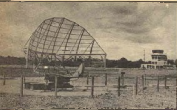
Il radar di sorveglianza Marconi S.232; di questo radar, che opera su una banda di 50 cm, solo l'antenna si trova al di sopra del terreno.
