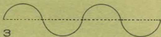
Fig. 3 - Rappresentazione grafica di una ottava-seconda armonica. I cicli della nota sono 440 \text{ Hz} \times 2 = 880 \text{ Hz} .
