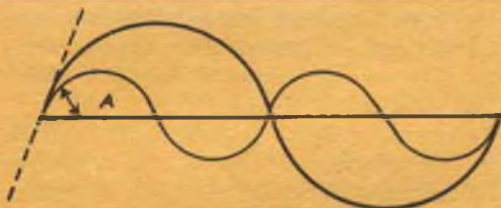
Fig. 11 - Rappresentazione grafica di un ciclo e della sua ottava di uguale energia. L'angolo A rappresenta la velocità.
