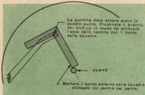
Fig. 3 - Per questa operazione usate una squadra a L a testa scorrevole. La punta dovrà essere posta nell'angolo tra i due bracci della squadra.
