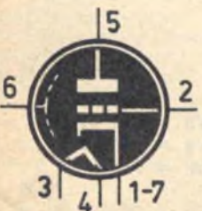
6FH5 TRIODO AMPLIFICATORE (zoccolo miniatura)
