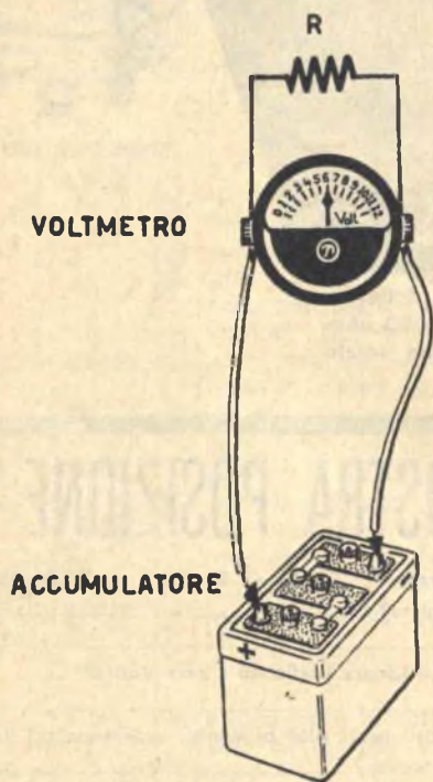
Fig. 1 - La resistenza R, collegata in parallelo al voltmetro, permette un normale flusso di corrente tra i morsetti della batteria senza il quale la tensione indicata dall'indice del voltmetro risulterebbe falsata in eccesso.
