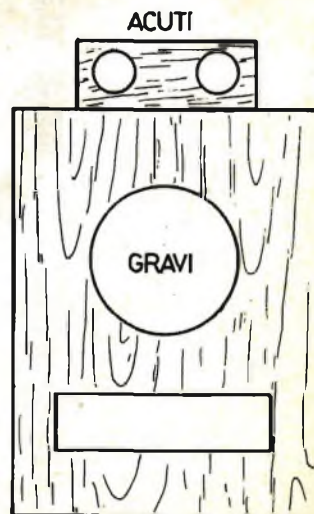
Fig. 4 - Così si presenta, anteriormente, un mobile bass-reflex nel quale sono stati aggiunti due altoparlanti per la riproduzione delle note acute.
