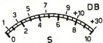
Fig. 3 - Per comodità di disegno abbiamo riportato nella scala, che il lettore dovrà comporre per l'S-Meter, la sola numerazione dispari dall'1 al 9. Oltre l'S9 la numerazione procede di 10 in 10 decibel fino all'S9 + 30 decibel.
