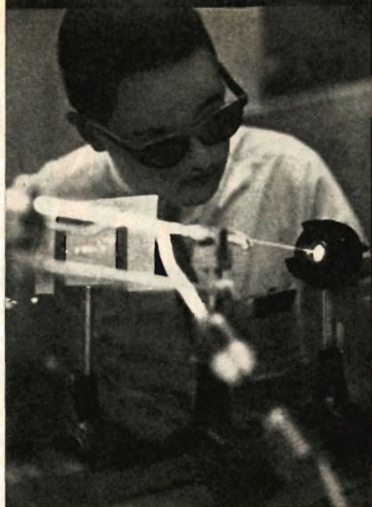
Un ingegnere mette in moto un Laser di cesio allo stato gassoso in un banco di prova ottico.
