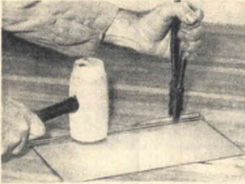
Fig. 14-15 - A sinistra e sopra è illustrato il procedimento per ottenere la piegatura circolare di un bordo di lamiera.
