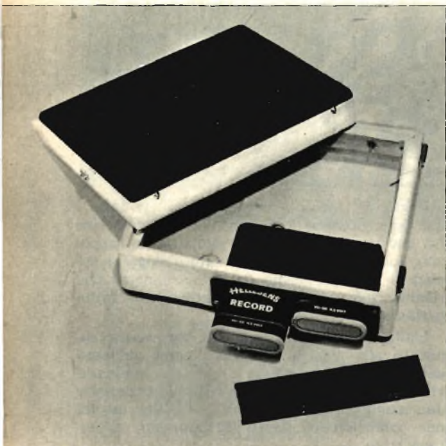
Fig. 6 - Il contenitore delle pile risulta già applicato internamente alla cassetta. Le pile da 4,5 V. non possono essere introdotte a casaccio nel contenitore, ma secondo la polarità indicata sul cerchio scorrevole riprodotto a pie' di figura.
