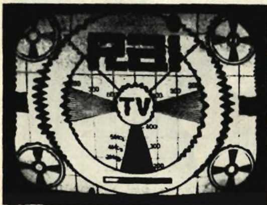
Fig. 7 - L'effetto di ruota dentata, che si manifesta sul monoscopio, è quasi sempre dovuto a tracce di tensione alternata sul CAF.
