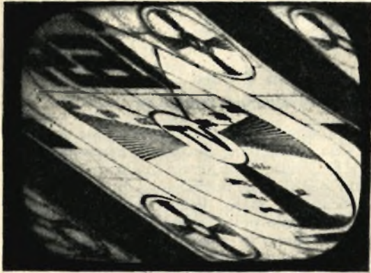
Fig. 5 - Perdita contemporanea dei sincronismi orizzontale e verticale.
