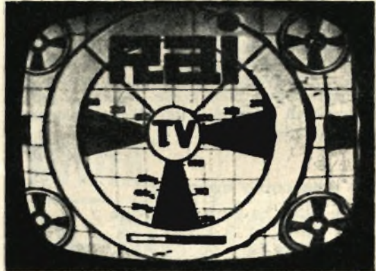
Fig. 8 - Sincronismi instabili — immagine spostata — lati ondeggianti: insufficiente livellamento della tensione anodica della valvola oscillatrice.
