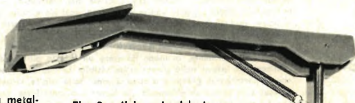
Fig. 8 - Il braccio del giradischi risulta già montato in tutte le sue parti essenziali; il compito del lettore è quello di fissarlo sulla faccia anteriore della piastra metallica.
