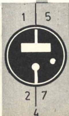
Fig. 3 - Circuito teorico indicativo su cui si effettua il calcolo della resistenza R. Fig. 4 - Simbolo elettrico, con la numerazione degli elettrodi nello zoccolo, della valvola a gas tipo OB2 (il puntino sta ad indicare che si tratta di valvola a gas).
