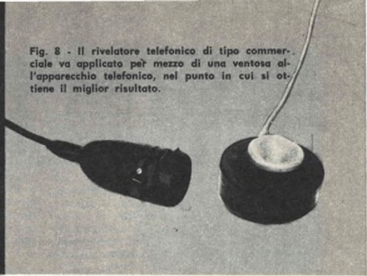
Fig. 6 - Le bobine captatrici di tipo commerciale si trovano in commercio sotto il nome di « rivelatori telefonici ».
