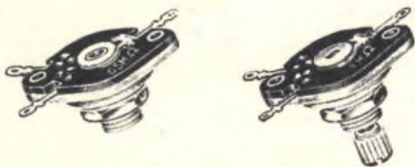
Fig. 4 - Due tipi di potenziometri impiegati per la regolazione della linearità nei circuiti di deflessione. Sotto, l'autotrasformatore di uscita verticale.
