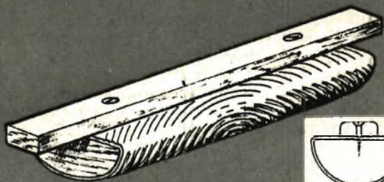
Fig. 1 - L'attrezzo che permette di imitare la venatura del legno è composto da un semicilindro di legno rivestito di gomma. L'impugnatura è costituita da una sbarretta di legno fissata mediante viti.
