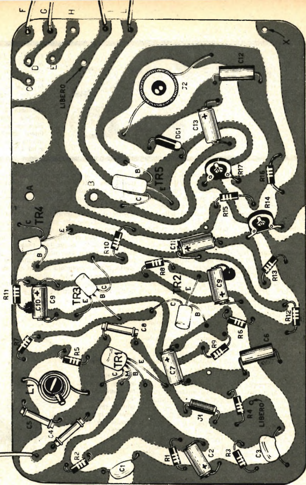
Fig. 8 - Questo schema pratico del ricevitore ha un valore puramente indicativo. Esso è stato così disegnato per chiarire e semplificare il lavoro di cablaggio. Nella realtà i componenti sono disposti verticalmente e molto vicini gli uni agli altri.
