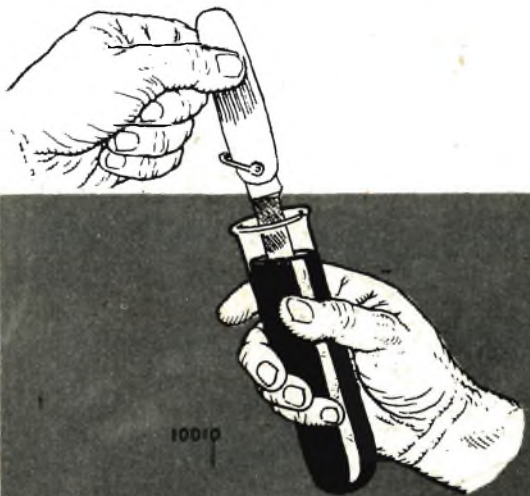
Fig. 6 - Effettuata la scrittura sulla lama occorre immergerla, fino a coprire lo scritto, nella tintura di jodio. La lama va lasciata immersa per circa mezz'ora e poi lavata, riscaldata e raschiata.
