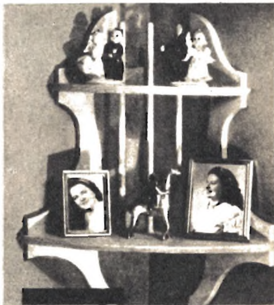
a) La struttura della mensola si compone di due piani orizzontali, di due montanti verticali e di tre tondini di legno che conferiscono rigidità e abbellimento all'insieme.
