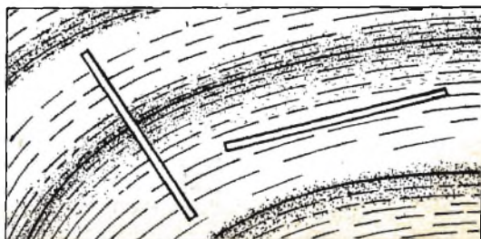
Fig. 3 - Tagliando le tavolette di balsa tangenzialmente od obliquamente al verso radiale del blocco si ottengono differenti compattezze delle fibre con vari gradi di durezza e robustezza.
