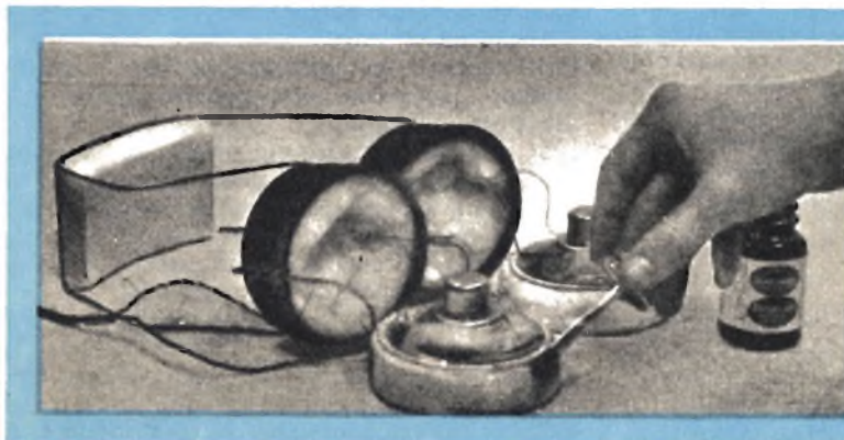
Fig. 5 - Il comune collante cellulosico servirà per far aderire gli anelli di gommapiuma agli involucri di plastica.
