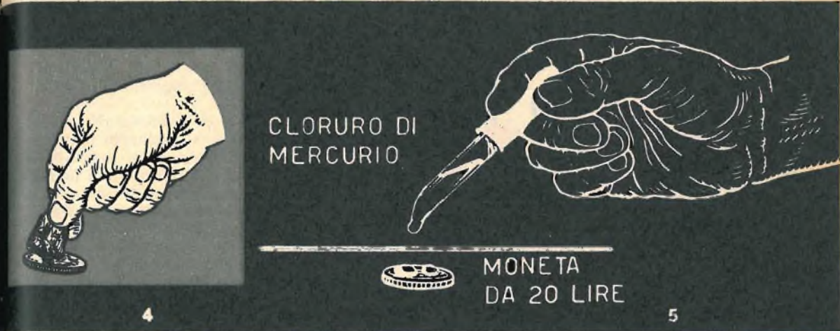
Fig. 4 - 5 - Per effettuare l'esperienza della nichelatura rapida occorre preparare una soluzione di acqua e cloruro di mercurio. Basterà versare alcune gocce della soluzione su una moneta da venti lire, aspettare qualche minuto, versare via il liquido e sfregare la moneta con carta di giornale.
