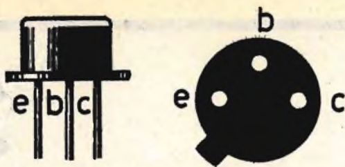
Fig. 7 - Tutti i transistori utilizzati nel ricevitore descritto sono caratterizzati dalla presenza di una tacchetta-guida in corrispondenza dell'emittore.
