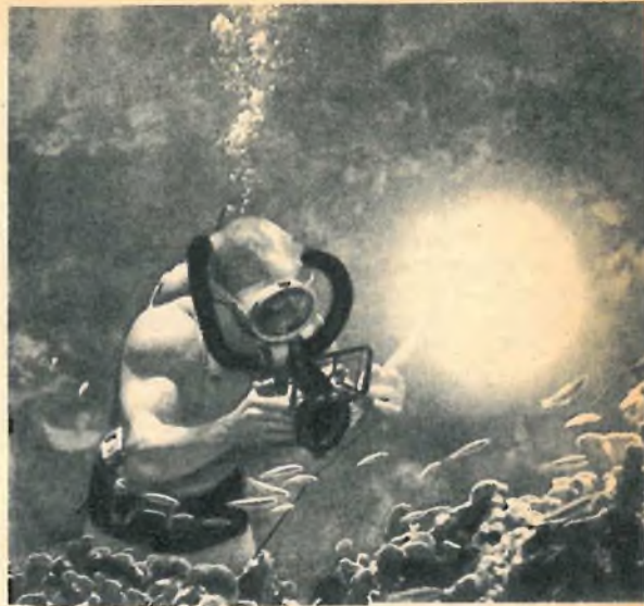
Fig. 2 - Questo tipo di camera stagna è sprovvisto dei piani alari che, pur essendo molto utili, non sono strettamente necessari.
