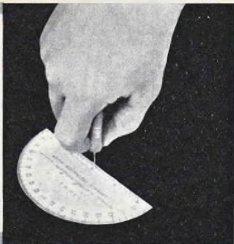
Fig. 2 - Un punteruolo si presta assai bene per praticare il forellino entro il quale si farà passare il filo d'acciaio.
