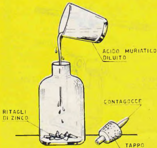
Fig. 1 - L'apparecchio necessario per ottenere l'idrogeno si compone semplicemente di una boccettina di plastica, di un contagocce e di un tappo di sughero o di gomma.
