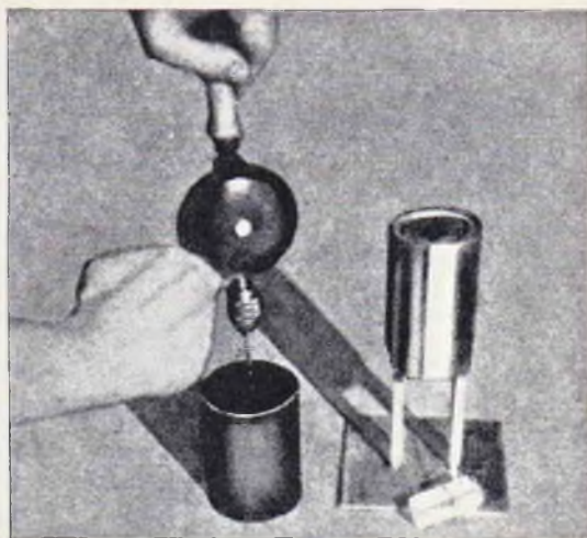
Fig. 2 - La goccia d'acqua, deposta sopra il forellino del barattolo mobile mediante un contagocce, assume la forma di una lente biconvessa.
