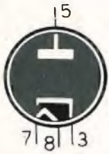
25AX4GTB DIODO PER USO TV (zoccolo octal)
