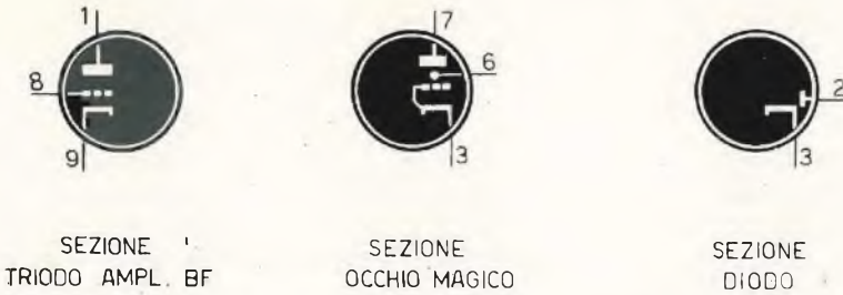
Fig. 3 - In questo disegno il simbolo elettrico dell'indicatore catodico è scomposto nelle sue tre sezioni componenti.
