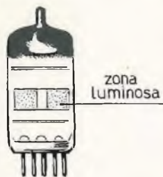
Fig. 1 - La zona luminosa dell'indicatore catodico EAM86 occupa una fascia orizzontale, di forma rettangolare, sul bulbo di vetro del tubo. L'effetto ottico si manifesta attraverso una separazione o un avvicinamento delle due fasce.
