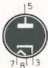
25AX4 DIODO PER USO TV (zoccolo octal)
