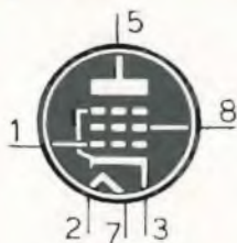
25AV5 PENTODO PER USO TV (zoccolo octal)
