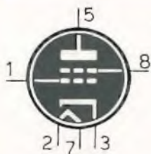
25AV5GA TETRODO PER USO TV (zoccolo octal)
