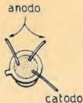
Fig. 4 - Il diodo tunnel è munito di tre terminali; due di questi sono perfettamente identici tra di loro, perché sono collegati entrambi con l'anodo; il terzo terminale è collegato con il catodo.
