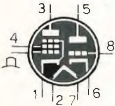
25B8 TRIODO PENTODO AMPLIFICATORE (zoccolo octal)
