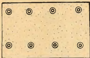
Fig. 3 - Su questa piastrina di materiale isolante, opportunamente rivettata, si applicheranno i componenti elettronici del microtrasmettitore.
