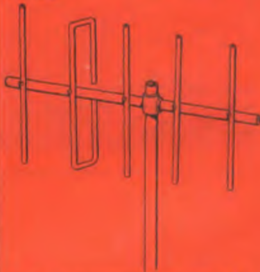
Fig. 4 - La polarizzazione dell'antenna TV è strettamente collegata con la posizione della antenna stessa sull'asta di sostegno. L'antenna qui raffigurata è polarizzata verticalmente.
