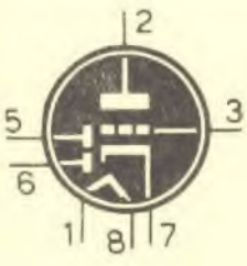
14E7 DOPPIO DIODO PENTODO RIV. AMPL. B.F. (zoccolo loctal)
