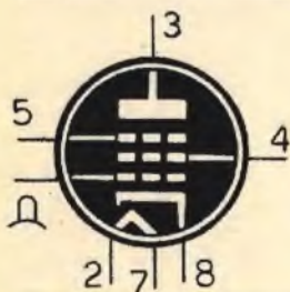
12J7 PENTODO AMPL. AF (zoccolo octal)
