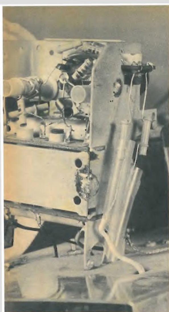
Particolare del gruppo FM. In basso, a destra, si notano i collegamenti con la presa di antenna FM e il collegamento della calza metallica con la massa.
