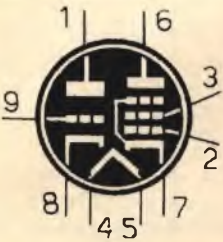
9EA8 TRIODO-PENTODO CONVERTITORE (zoccolo noval)
