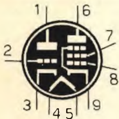
10C8 TRIODO-PENTODO PER USO TV (zoccolo noval)
