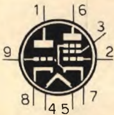
9U8 TRIODO-PENTODO CONVERTITORE (zoccolo noval)
