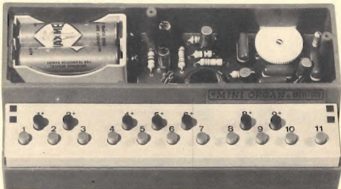
Fig. 7 - La foto illustra il miniorgano nella sua fase finale di montaggio, in esso mancano soltanto i coperchietti di chiusura in plastica.
