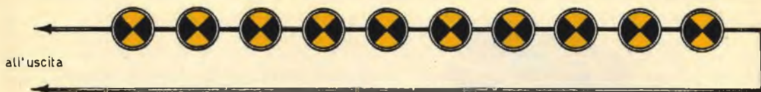
Fig. 4 - Su tutte e tre le uscite, corrispondenti ai tre canali amplificatori, si applicheranno dieci lampadine, collegate in serie tra di loro, da 6,3 volt-50 mA.
