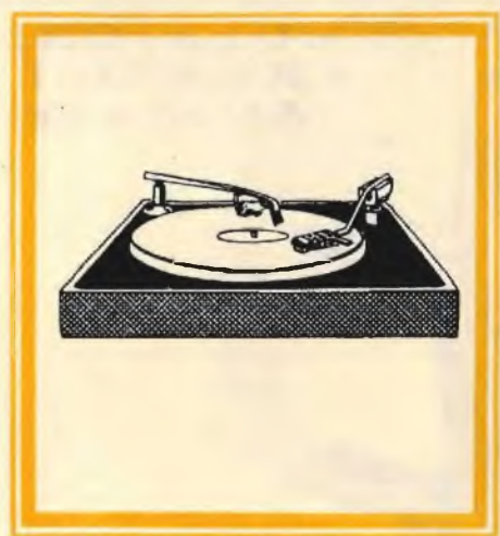
Fig. 4 - Un altro sistema per mantenere costantemente pulito il disco consiste nell'applicare sul disco stesso un bilanciere munito di spazzolina e un piccolo rullo di peli flessibili atto a raccogliere la polvere.
