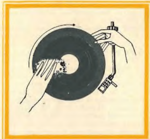
Fig. 3 - Il sistema più comune per raggiungere una buona pulizia delle superfici del disco consiste nel far ruotare il disco stesso sul piatto giradischi, a mano, mentre si strofina su di esso una spazzola con peli di seta antistatici.
