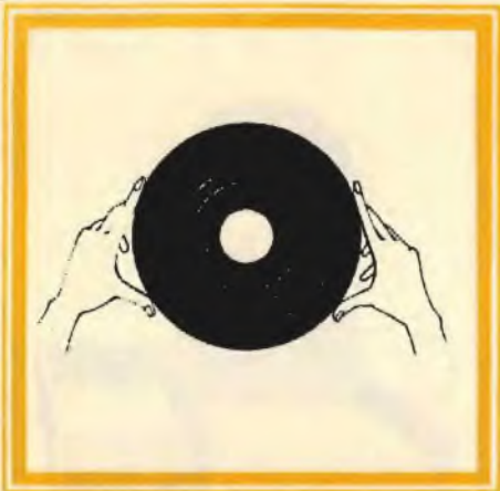
Fig. 2 - Il grasso lasciato sui solchi del disco dalle dita della mano finisce, a lungo andare, per impastare la polvere e occultare le ondulazioni dell'incisione. La presa corretta dei dischi è quella rappresentata in figura.
