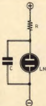
Fig. 3 - La corrente continua fa accendere un solo elettrodo della lampadina al neon; la corrente alternata accende entrambi gli elettrodi.
