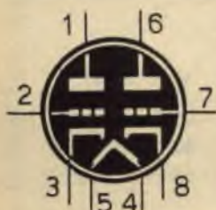
7ES8 DOPPIO TRIODO AMPL. VHF (zoccolo noval)
