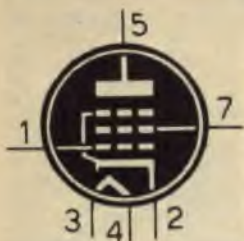
7D9 PENTODO FINALE B.F. (zoccolo miniatura)
