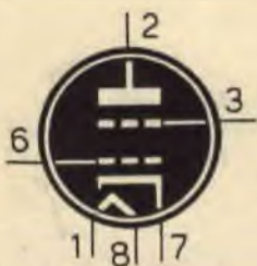
7C5 TETRODO FINALE B.F. (zoccolo loctal)
