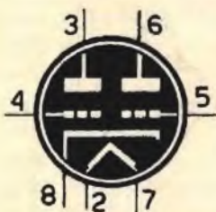
6N7 DOPPIO TRIODO PER PUSH-PULL B.F. (zoccolo octal)
