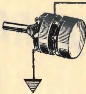
Fig. 4 - Il potenziometro doppio è costituito da due potenziometri comandati simultaneamente da un unico perno.
